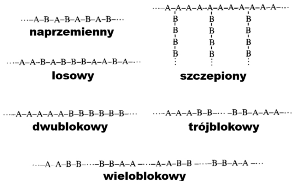
Rysunek 23: Typy kopolimerów [142]; litery A i B oznaczają różne typy monomerów.
