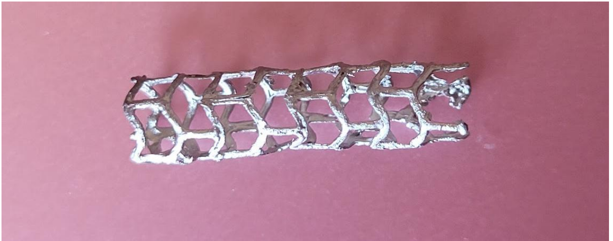
Rys. 20.1 Przykład struktury o geometrii stentowej otrzymanej metodą replikacji przestrzennej z wykorzystaniem szablonu PLA i proszku żelaznego.
