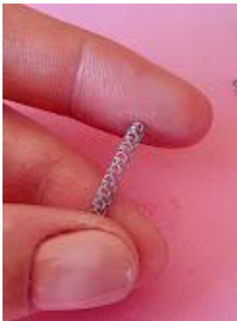
Rys. 20.3 Fragment struktury po manualnym odkształceniu – widoczne lokalne zapadnięcia, zerwania połączeń oraz trwała deformacja geometryczna, wskazujące na ograniczoną stabilność strukturalną wytworzonego rusztu.
