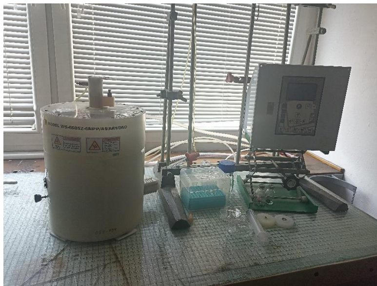
Rys. 5.1. Spin-coater Laurell WS-650SZ-6NPP/A1/ARI/OND, używany do wytwarzania cienkich warstw.
