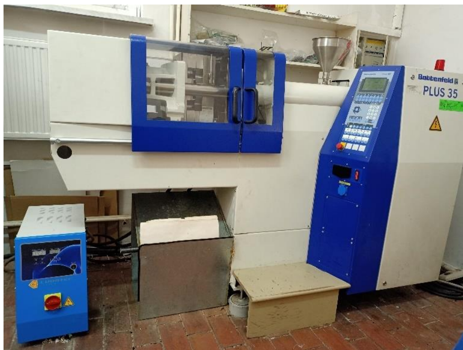
Rysunek 27. Wtryskarka laboratoryjna – PLUS 35 Battenfeld (Battenfeld, Niemcy).
