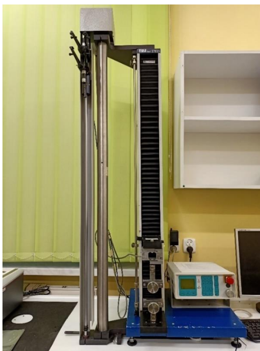
Rysunek 30. Urządzenie do przeprowadzenia badań statycznego rozciągania – TIRAtest 27025 (TIRA GmbH, Niemcy).
