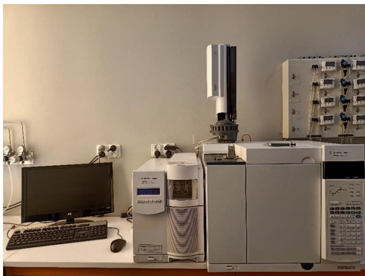
Rysunek 35. Chromatograf gazowy ze spektrometrem mas – Agilent Technologies 7820A, Agilent GC/MSD 59772.
