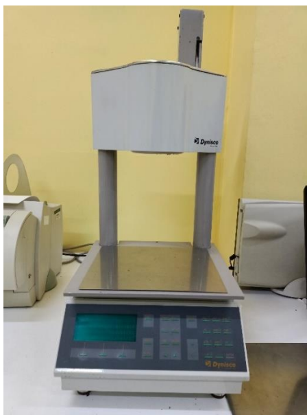
Rysunek 34. Urządzenie do MFR – LMI 4003 (Dynisco, USA).
