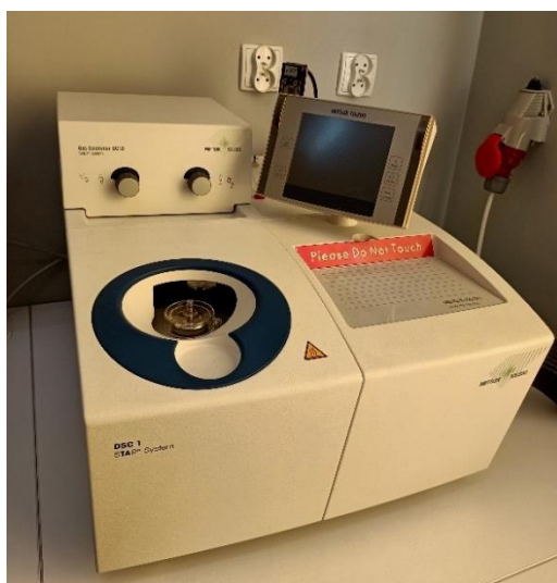
Rysunek 33. Aparat DSC – DSC1 (Mettler Toledo, Szwajcaria).
