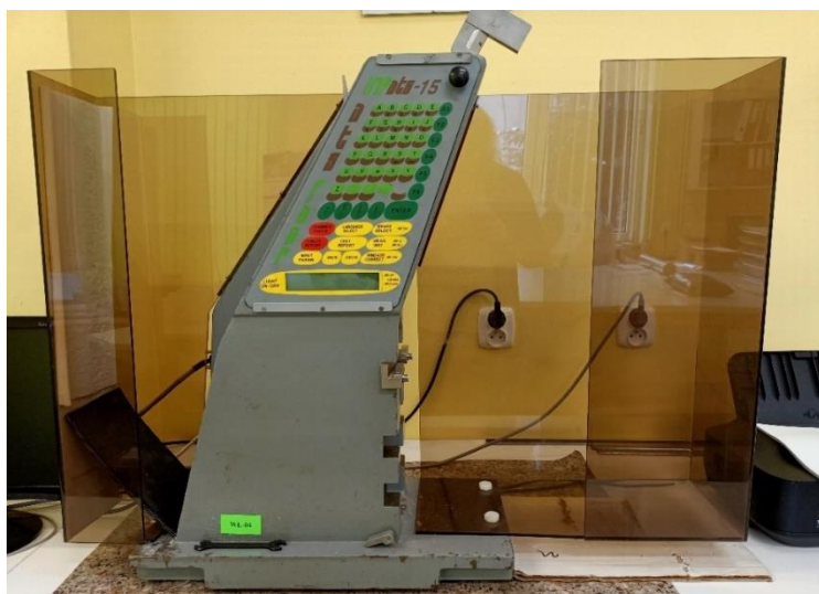
Rysunek 28. Urządzenie do badań udarności– IMPats-15 (ATS FAAR, Włochy).
