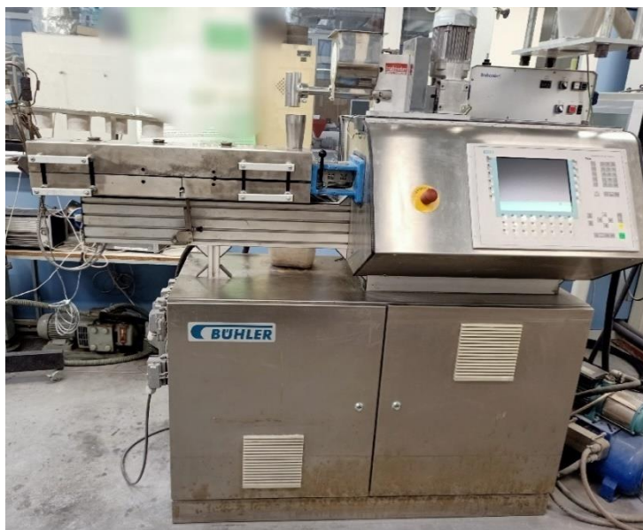
Rysunek 23. Wyłaczarka dwuślimakowa współbieżna typu BSK 20 / 40D (Bühler, Szwajcaria).
