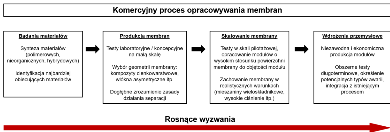
Rys. 1 Uproszczony diagram obrazujący typowy schemat badań wdrożeniowych nowych membran przemysłowych
