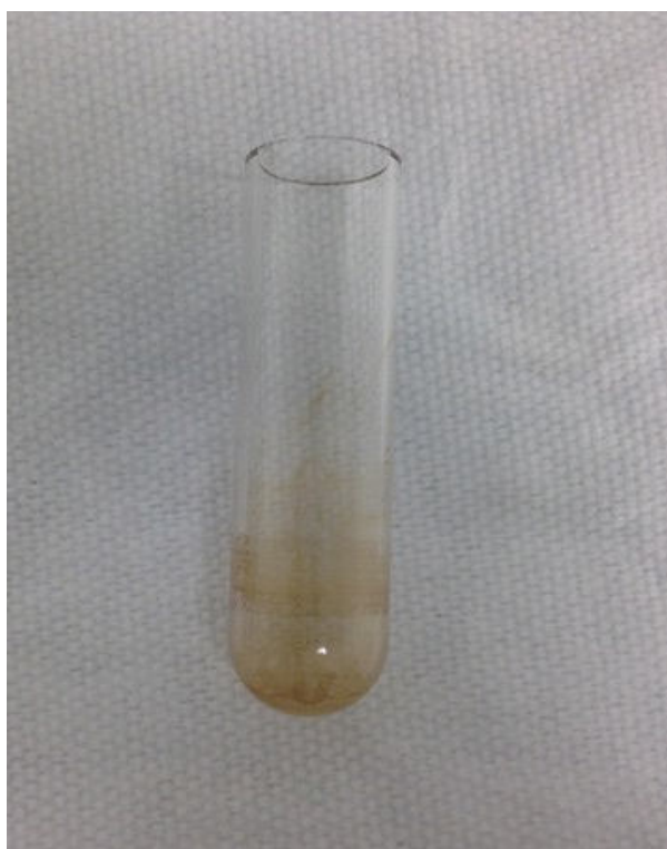
Rycina 27. Nieoczyszczony reaktor po procedurze automatycznego czyszczenia (zdjęcie własne).
