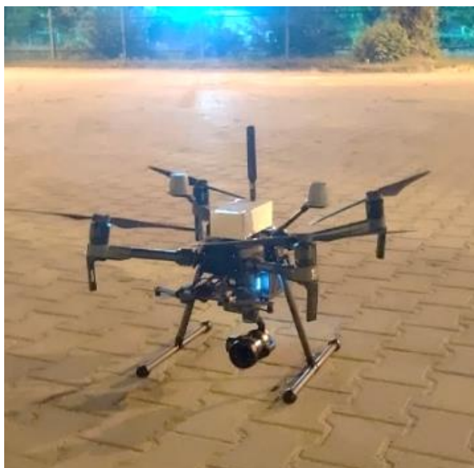
Rycina 6. Wykorzystany BSP firmy DJI model Matrice 210 RTK z autorskim urządzeniem pomiarowym służący analizie zmienności jasności powierzchniowej nocnego nieba w gradiencie pionowym (fot. Dominika Karpińska).
