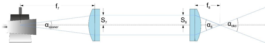
Rys. 3.1.14 Zależności kątowe między kątem skanowania a kątem wiązki wchodzącej do oka. Fragment toru doprowadzającego wiązkę do oka: SS - skanery, teleskop złożony z soczewek L_7 i L_8 o ogniskowych odpowiednio f_7 i f_8 , \alpha_{skaner} - kąt skanowania skanerów, \alpha_{oko} = \alpha_8 - kąt wiązki wchodzącej do oka (rozmiar kątowy bodźca w oku).
