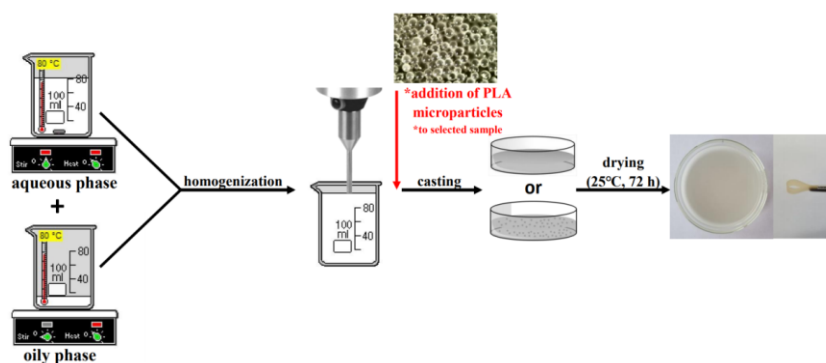
Rysunek 5. Schemat otrzymywania filmów emulsyjnych [H8]
