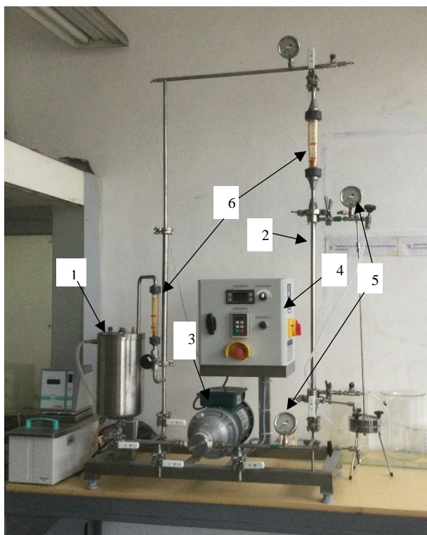
Rysunek 9. Laboratoryjna instalacja stosowana do badania technik membranowych. 1 - Zbiornik procesowy, 2 - Moduł membranowy, 3 – Pompa, 4 - Panel sterujący, 5 – Manometry, 6 – Rotametry.
