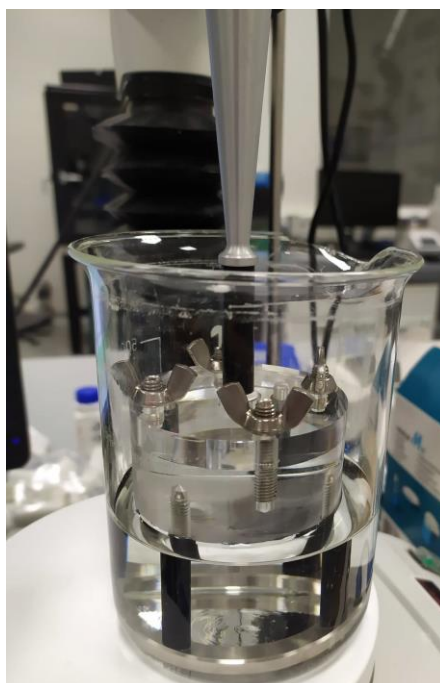
Rycina 33. Analizator tekstury z podstawką A/Muc w trakcie badania mukoadhezji.
