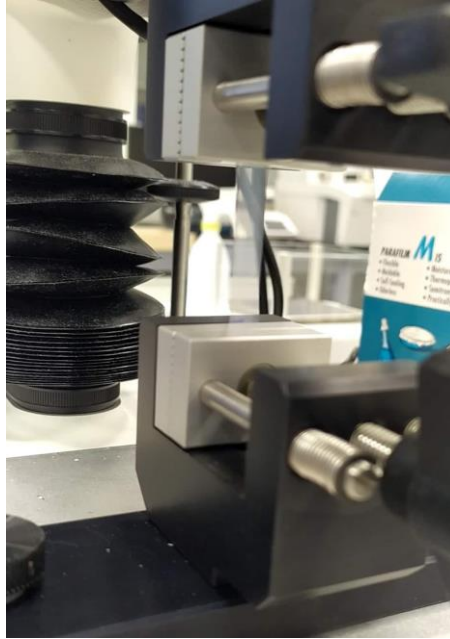
Rycina 31. Analizator tekstury z zamocowaną lamelką w trakcie pomiaru wytrzymałości na rozciąganie.
